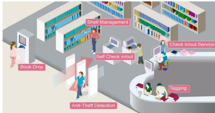
**Figura 13. Sistema RFID en biblioteca y sus componentes.**
