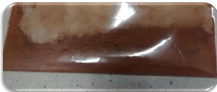
Fig. 11 Diatomea recubierta con Cloruro Férrico a pH 9, el color evidencia la presencia de hierro
