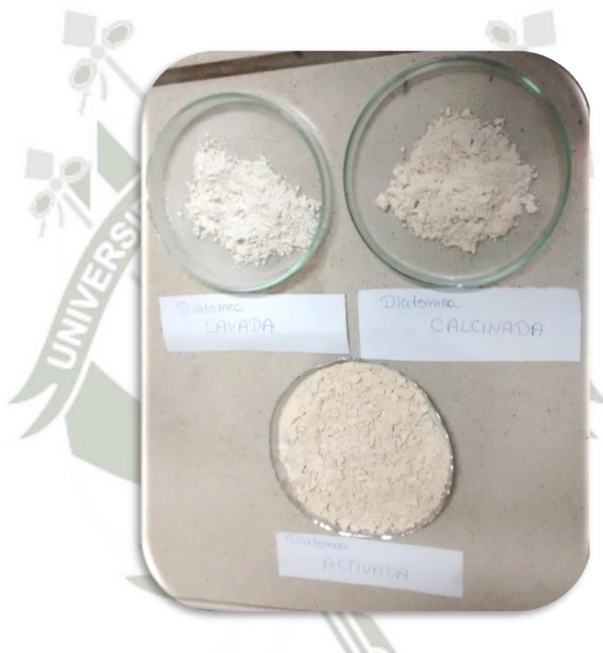
Fig. 9 Se observa el cambio de color de las diatomeas, conforme va siendo sometida a lavados, hasta obtener diatomeas libres de materia orgánica y demás impurezas.
