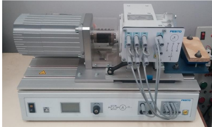
Figura 66. Banco de pruebas para motores – FESTO. Fuente: Elaboración propia.
