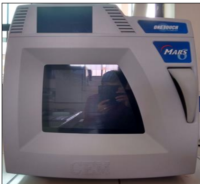
FIGURA 2.5. Digestor microondas MARS utilizado para realizar las digestiones de raíces y hojas de Bacopa monnieri L. (Hisopo de agua).
