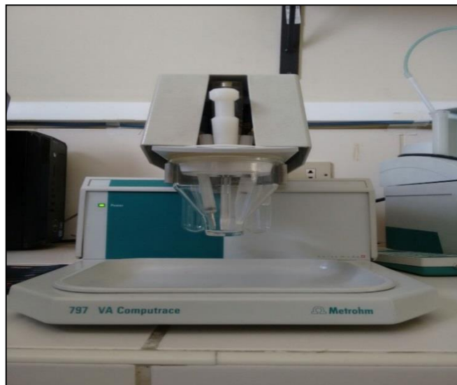
FIGURA 2.4. Estación voltamperométrica 797 VA Computrace utilizado para la determinación de selenio (IV).
