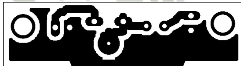
Fig. 3 Diseño del circuito impreso de la fuente de luz.
