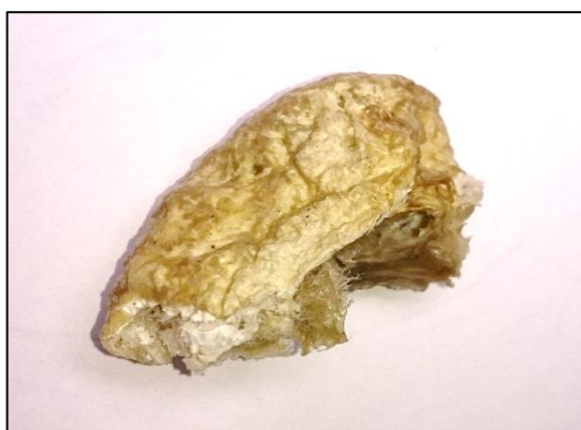
Figura 20. Carragenina extraída en el laboratorio.
