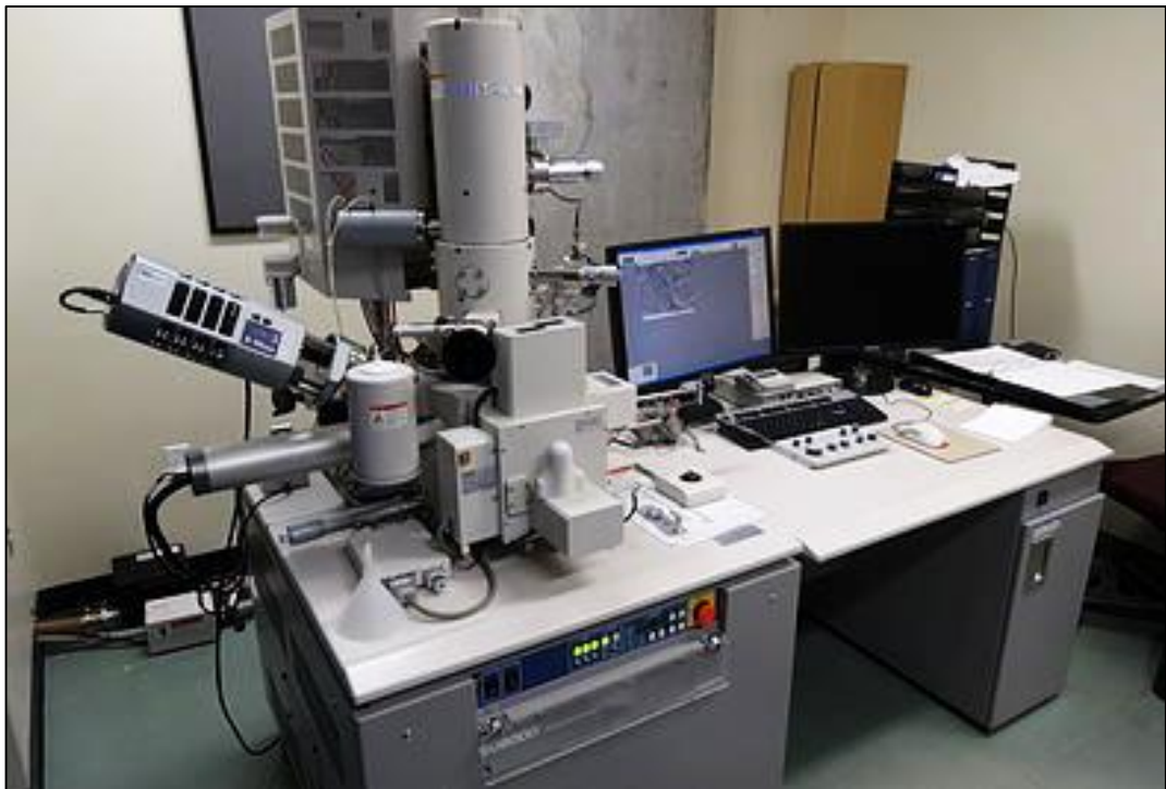
Figura 30. Microscopio electrónico de barrido de emisión de campo SU 8000 Hitachi.
