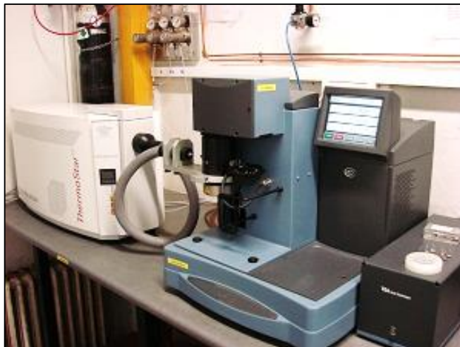
Figura 27. Analizador termogravimétrico TA Instruments TA Q500.
