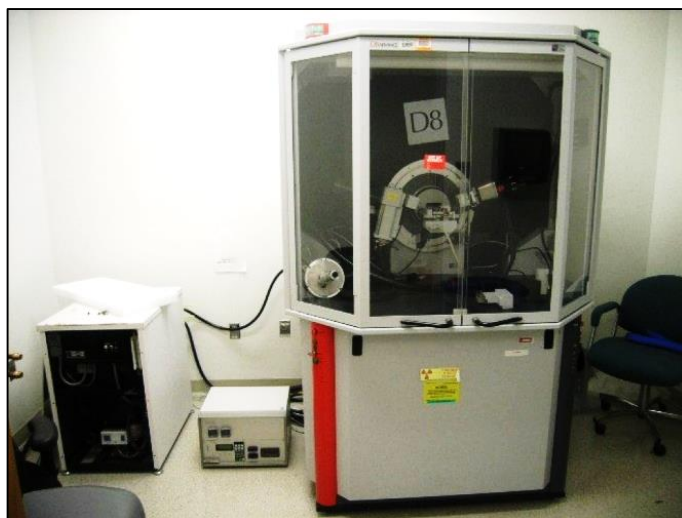
Figura 23. Difractómetro Bruker D8 Advance.
