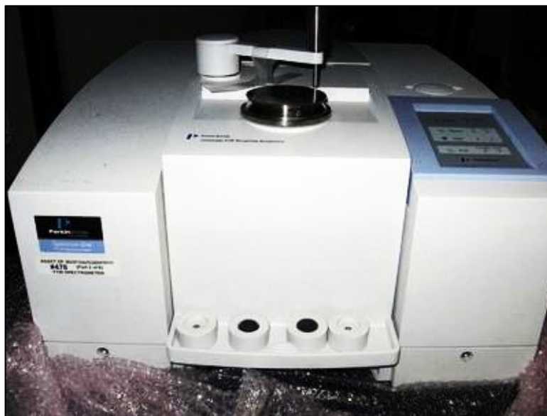
Figura 24. Espectrómetro FTIR Pelkin-Elmer Spectrum One.
