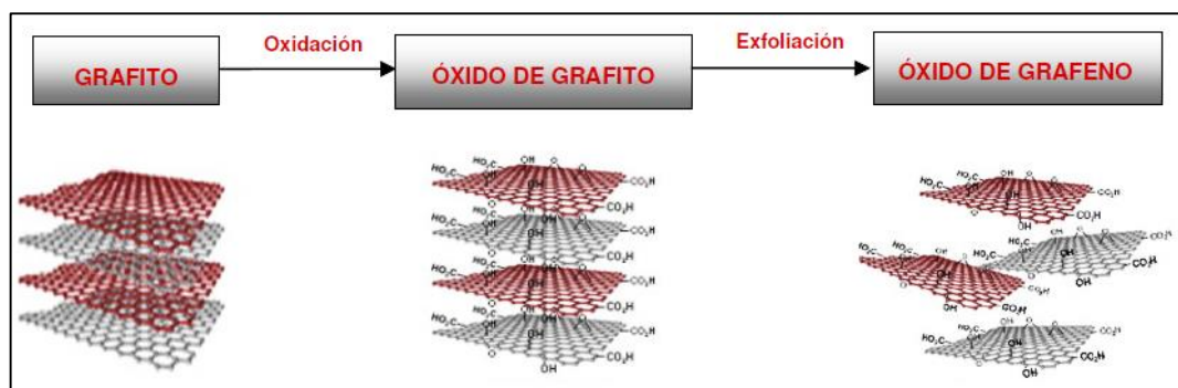
Figura 9. Proceso de síntesis de óxido de grafeno.
