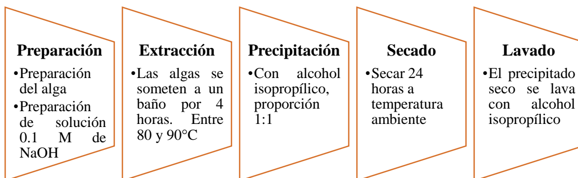
Figura 21. Proceso de extracción de carragenina.
