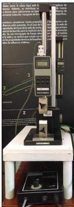
Figura 26. Máquina para ensayos de microtensión ESM Mark-10.
