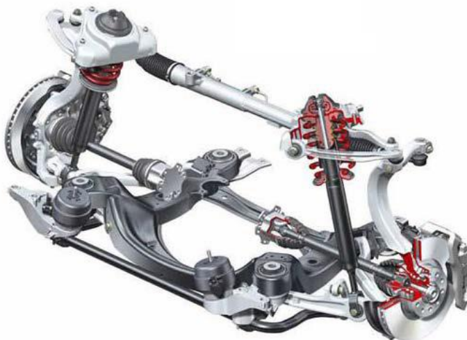
Figura 27. Sistema de suspensión multibrazo del eje delantero de un Audi A6.
