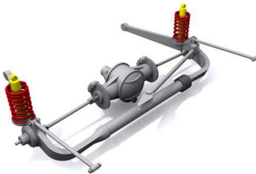
Figura 19. Esquema simplificado de una suspensión semirrígida con "Eje de Dion". Fuente: Proyecto de Fin de Carrera (Coronel Benavente, 2010).
