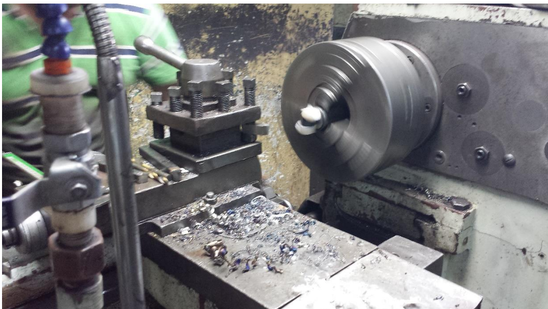
Figura 120. Proceso de fabricación e instalación en torno, de topes para colocación de amortiguador MR en sus respectivas extensiones. Fuente: Captura fotográfica propia.
