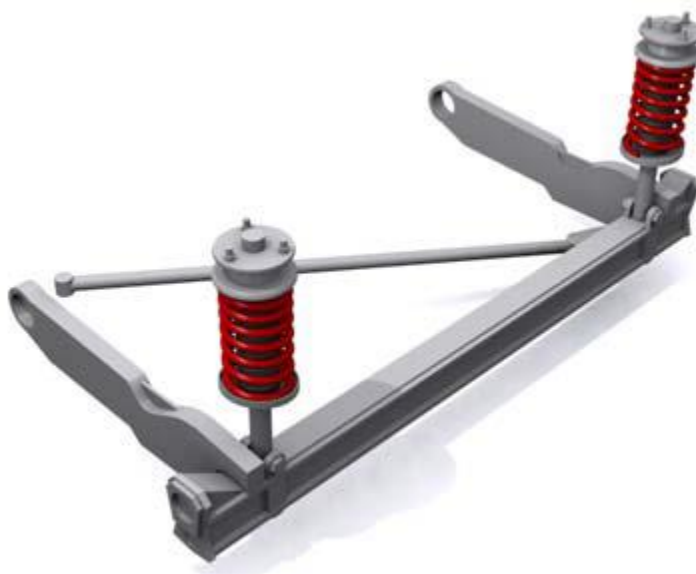
Figura 18. Esquema simplificado de una suspensión de eje rígido.
