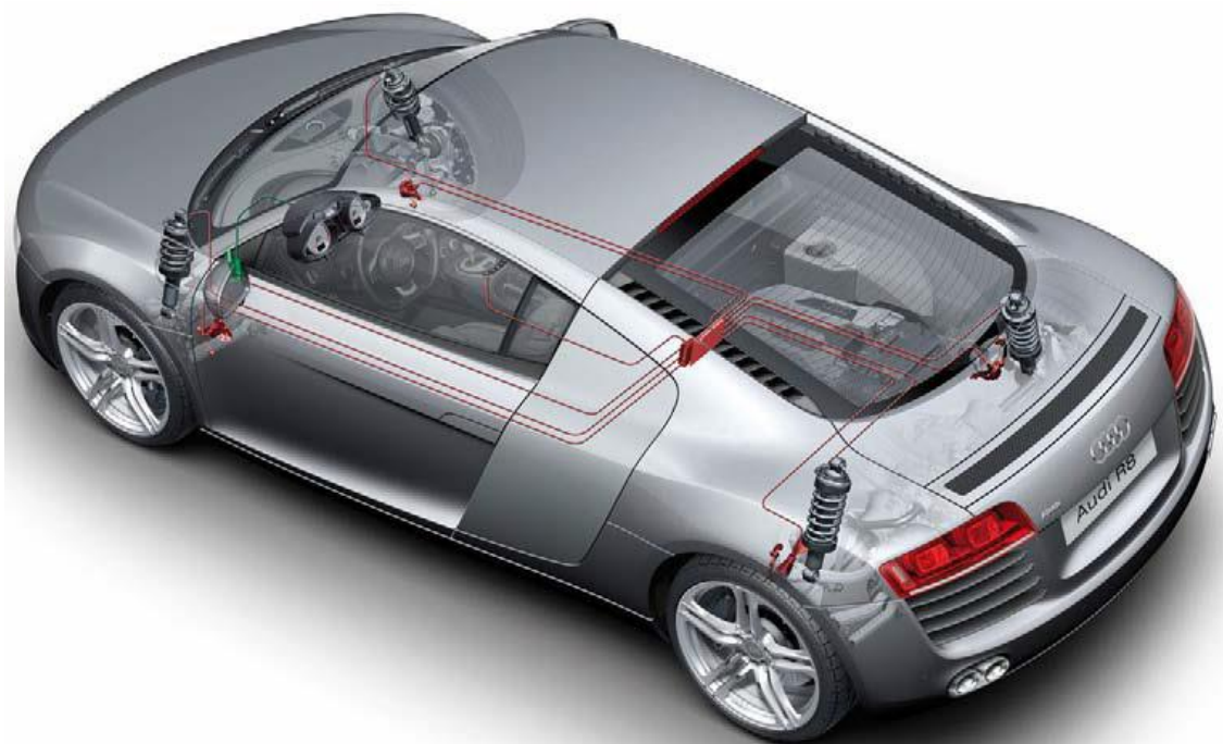
Figura 59. Audi R8 equipado con el sistema Magnetic Ride de Delphi. Fuente: Diseño de la suspensión de un vehículo (Chacón Hernando, 2010).
