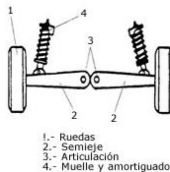
Figura 22. Componentes de una suspensión de eje oscilante. Fuente: Proyecto de Fin de Carrera (Chacón Hernando, 2009).
