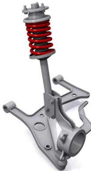
Figura 21. Esquema de una suspensión independiente de tipo McPherson. Fuente: Proyecto de Fin de Carrera (Coronel Benavente, 2010).
