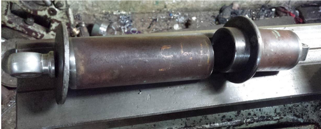
Figura 119. Extensiones fabricadas para el montaje del amortiguador MR en el kart . Fuente: Captura fotográfica propia.
