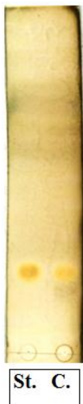
Figura III. 11 Placa TLC, donde se muestra las manchas de estándar de metamidofos (derecha) y metamidofos comercial (izquierda), bajo las condiciones establecidas.
