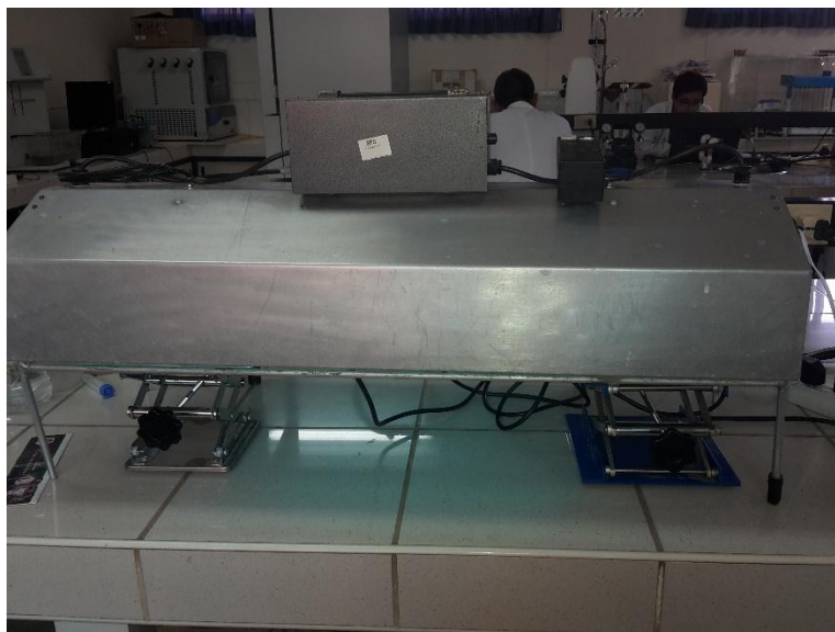
Anexo 8. 7 Lámpara UV-A de trabajo (emisión 365 nm).
