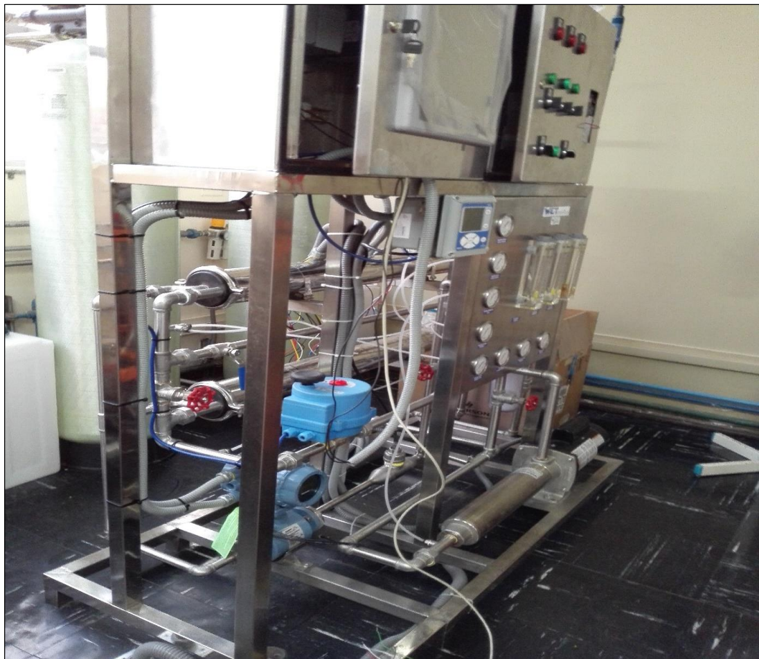
Figura 2.13. Planta piloto para desalinización de agua de la PUCP.
