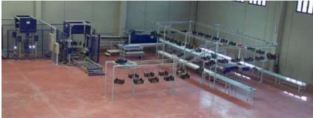
Fig.4.5. Calibrador electrónico de copas para una central hortofrutícola
