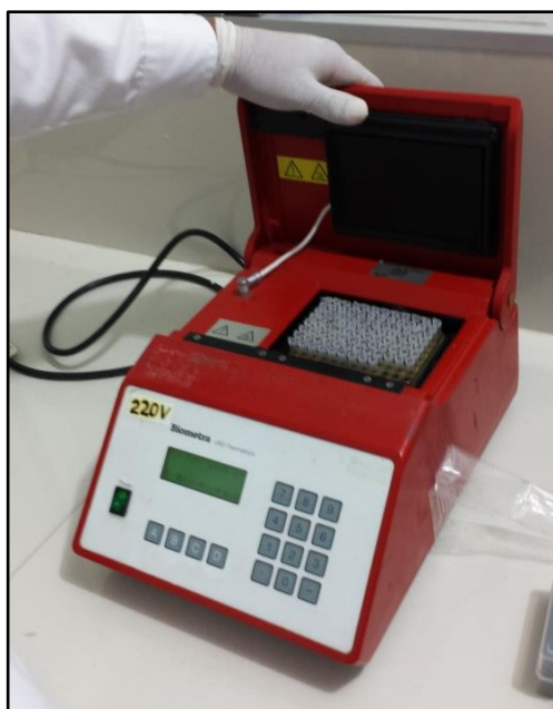
Figura 11. Amplificación mediante Reacción en Cadena de la Polimerasa (PCR), Termociclador con el programa 16S para bacterias.
