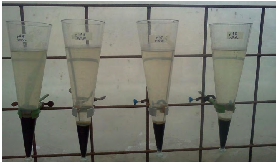
Figura N°3.2. Ensayos de Floculación y/o Coagulación en Conos Imhoff
