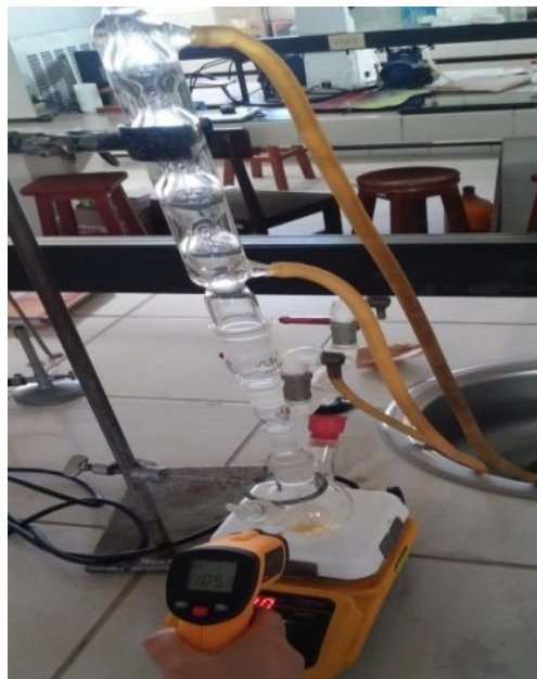
Figura 9. Disolución de fibra corta de vicugna pacos (alpaca) Raza huacaya (lavada y secada en estufa por 18 h) en [DEOA][HCOO].
