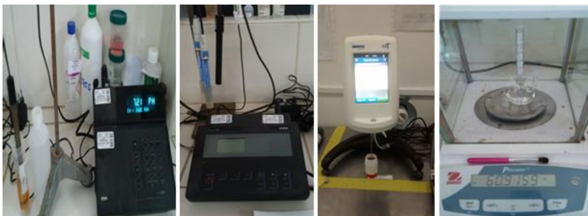
Figura 12: Instrumentos de medición utilizados en la lectura de pH, conductividad, viscosidad y densidad para [DMEA][HCOO] y [DEOA][HCOO]
