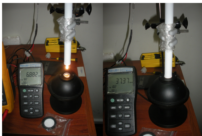
Figura 19: Proceso de evaluación de la lámpara IL1 usando la esfera PCE-LED.
