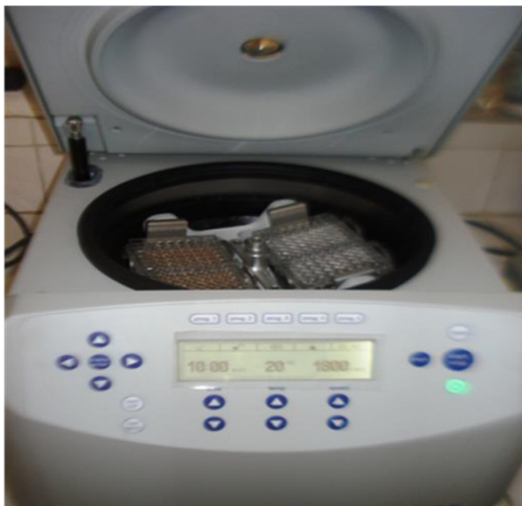
Las placas se centrifugaron a 1800 RPM/10 min.
