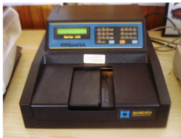
Las placas se leyeron en un lector de placas a 450 nm.
