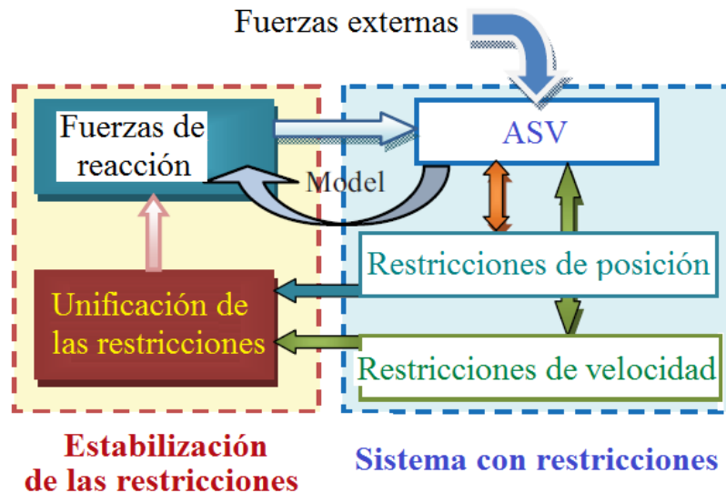
Figura 4.1. Diagrama esquemático de la metodología de control (Peymani & Fossen. 2012)
