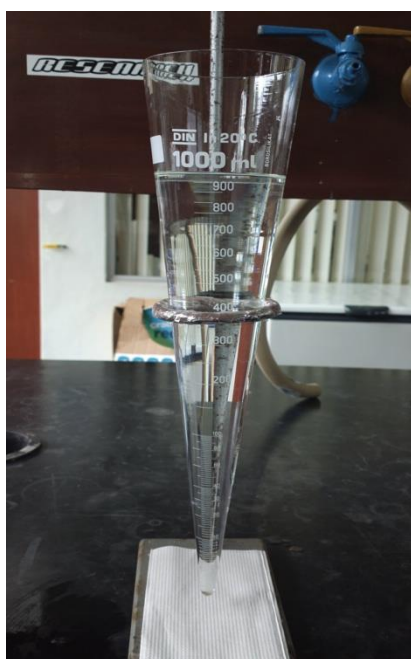
Figura 20. Determinación de sólidos sedimentables. Muestra de agua sedimentando en un cono Imhoff. Fuente: Propia
