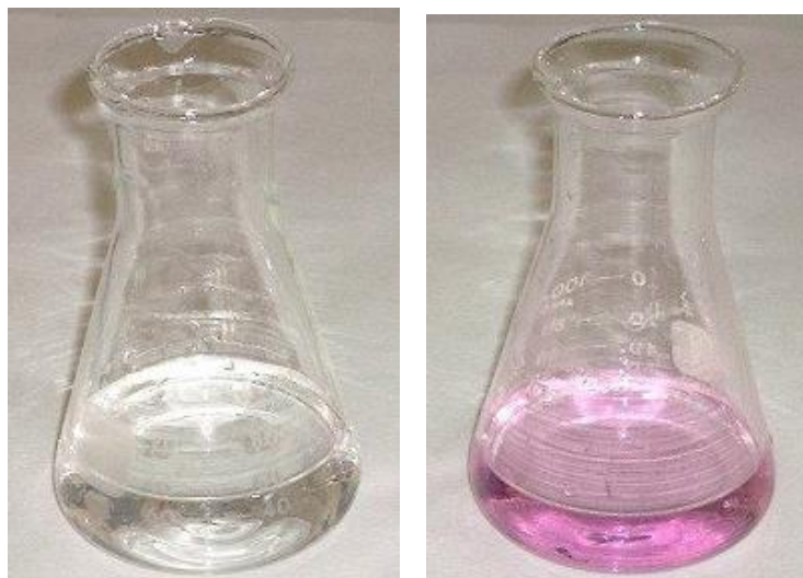
Figura 23. Determinación de DQO. Punto inicial de titulación (izquierda) y punto final de titulación (derecha). Fuente: Propia
