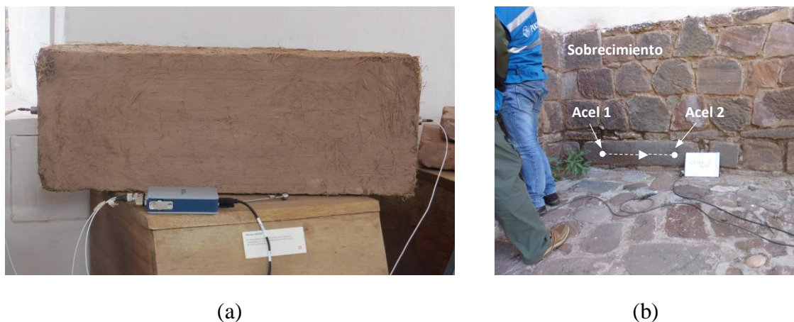
Figura 6.3 Ensayos sónicos en adobe y piedra. (a) Ensayos directos en adobe (b) Ensayos indirectos en piedras de sobre-cimiento.
