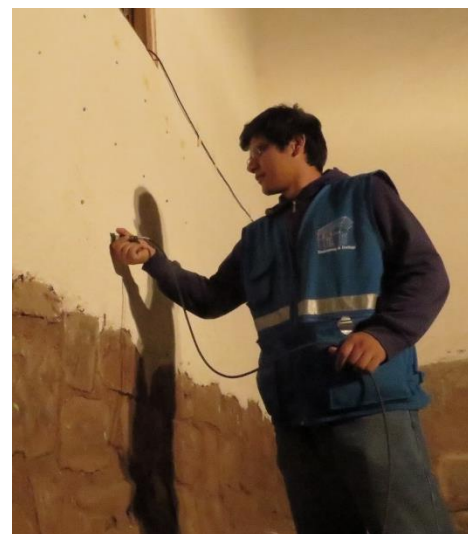
Figura 6.4 Mallas y configuración de ensayos sónicos (a) contrafuerte (b) muro de capilla.
