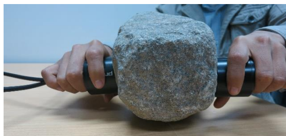
Figura 3.10 Resultados de ultrasonido de la muestra 4 de piedra (a) registros ultrasónicos (b) configuración de ensayo y resultados.
