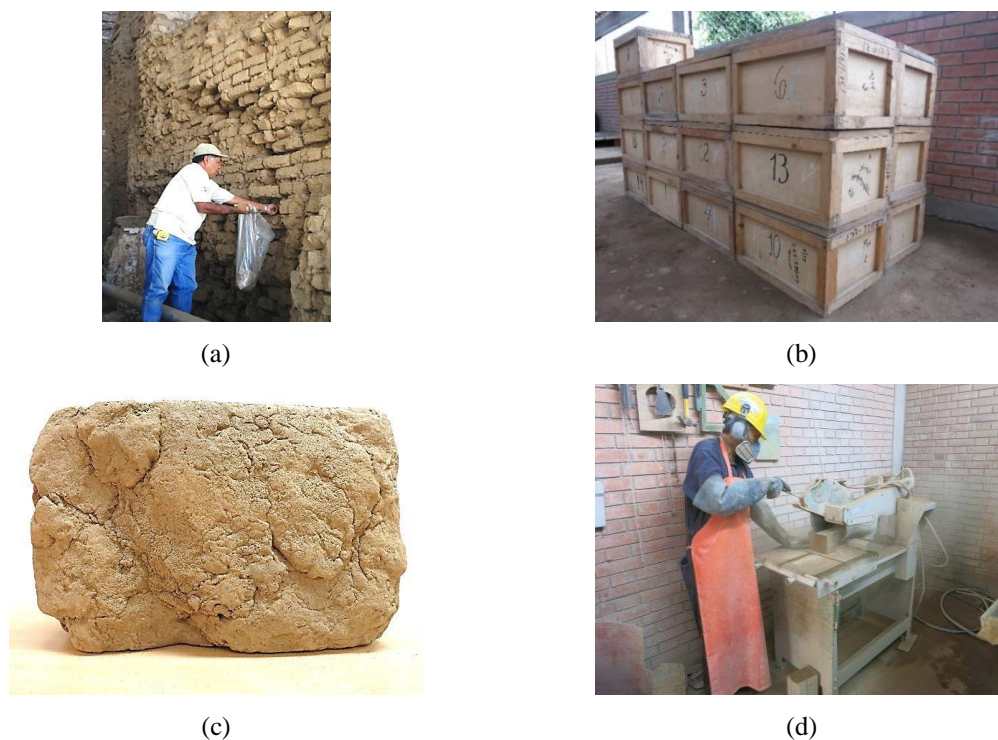
Figura 5.2 Especímenes de adobe de la Huaca de la Luna (a) proceso de obtención (b) protección para el traslado
