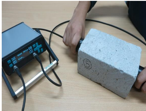
Figura 3.5 Registro de datos (a) Ensayos sónicos en una probeta de concreto y técnica empleada en todas las muestras (b) Prueba de ultrasonido en muestra de cantería.
