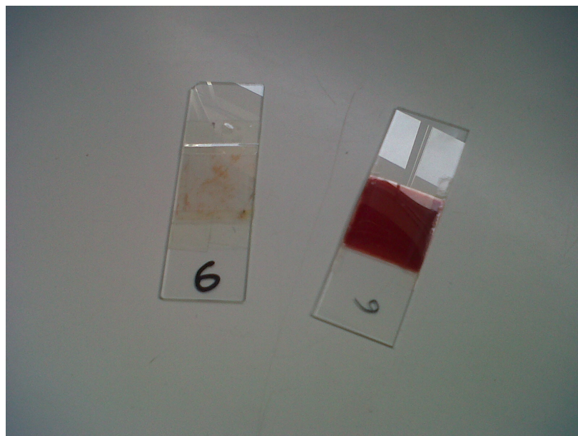
Figura 2.17: Detector degradado por UV ubicado en el techo de las 3 zonas.
