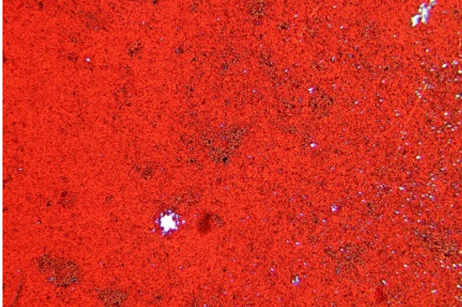
Figura B.4: Campo de 126,96\mu m^2 del detector LR-115 tipo en mediciones de desechos de Uranio 238.
