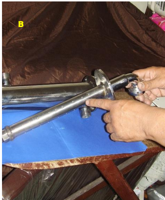
FIGURA 18. Mezclador gas –líquido de acero inoxidable, A) Vista de las dos unidades que conforman el mezclador y B) Observándose los orificios o perforaciones de intercambio.
