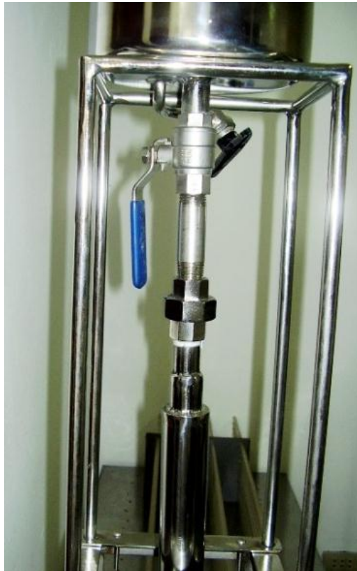
FIGURA 17. Vista parcial del Mezclador de cultivo-gases de combustión.
