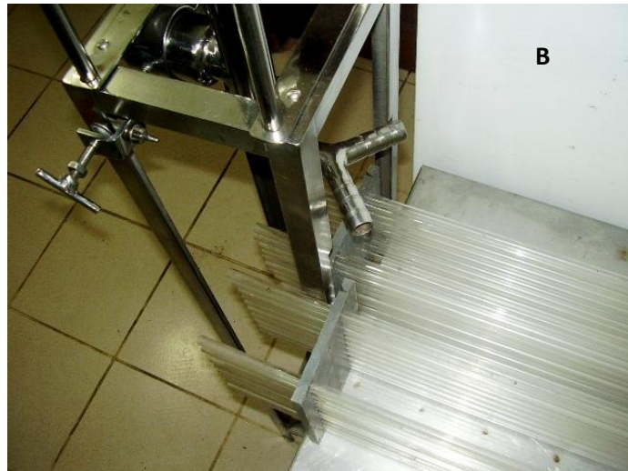
FIGURA 8. Instalación de Fotobiorreactor de tipo tubular. A) Observación de tubos de vidrio que conforman al fotobiorreactor. B) Vista de soporte de metal acoplándose con los tubos de vidrio.
