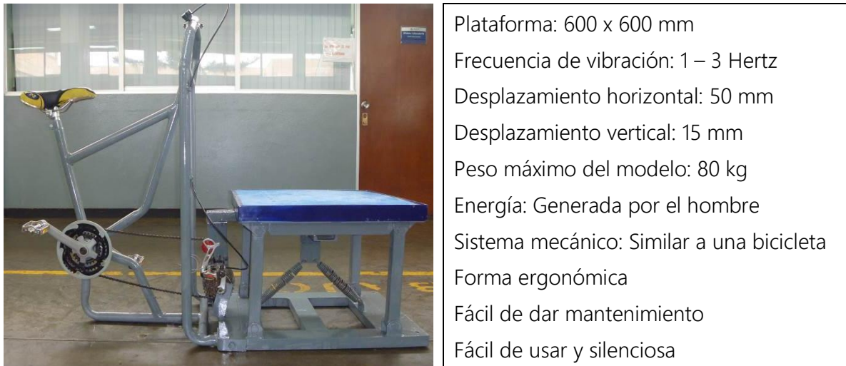
Figura 3.1. Especificaciones técnicas de la mesa vibratoria portátil desarrollada en la PUCP (Blondet y Rubiños, 2013).
