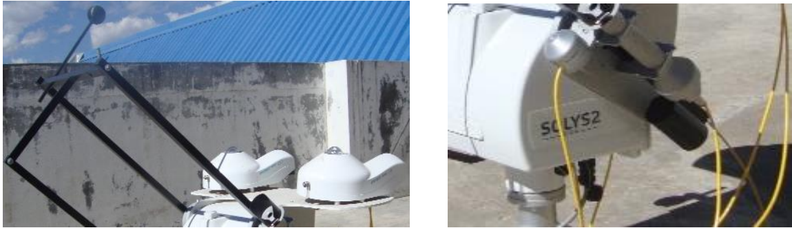
Figura 2.6: Piranómetro para medir radiación directa-difusa y Pirheliómetro.
