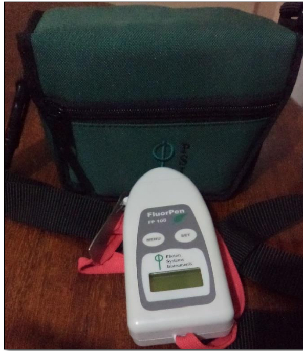
Anexo 28. Equipo Fluor Pen-100, para medir los parámetros de fluorescencia.
