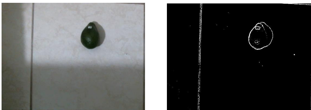
Figura 3.40: Imagen capturada de palta y detección de bordes – Luz baja
