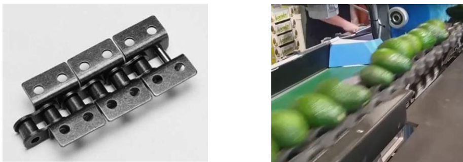
Figura 3.10: a) Cadenas ISO 606 con aletas K1. b) Disposición de cadenas con rodillos de y paltas.
