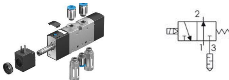
Figura 3.37: Válvula VUVS 3/2 FESTO – Vista de explosión (Izquierda). Símbolo según DIN ISO 1219 (Derecha).
