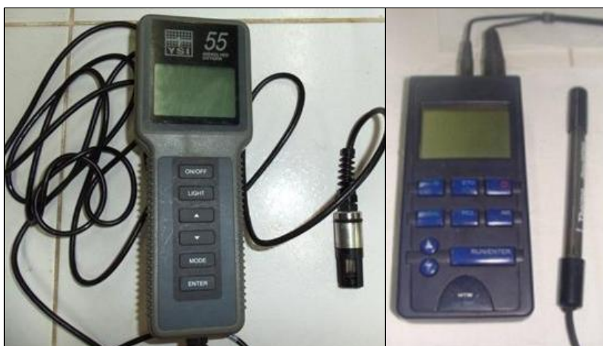
Figura 11. Equipo multiparámetro YSI 55 y pHmetro WTW 330i empleados para medir la concentración de oxígeno disuelto y la acidez de las aguas durante el estudio.
