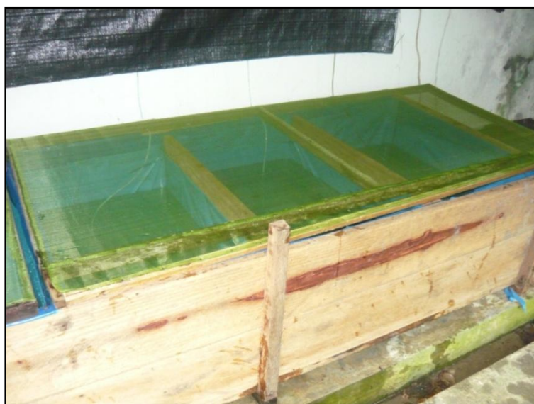
Figura 3. Vista de las unidades experimentales (artesanías de madera, revestidas con plástico) empleadas en el estudio.
