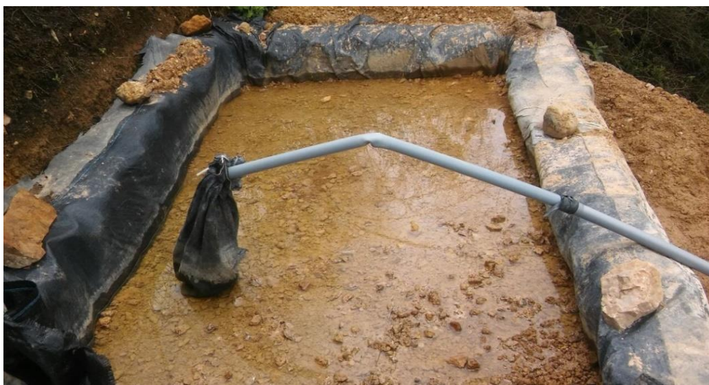
Imagen 1 Poza artesanal empleada para la lixiviación de oro con cianuro
