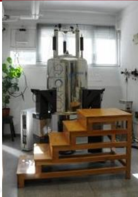
Figura 2.15. Equipo de resonancia magnética Varian Mercury 400.
