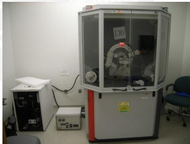
Figura 2.16. Difractómetro Bruker D8 Advance.
