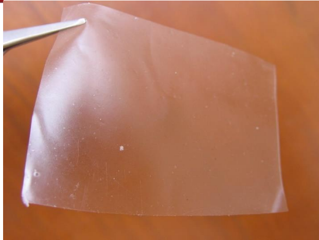
Figura 2.13. Película delgada de compuesto de carragenina.
