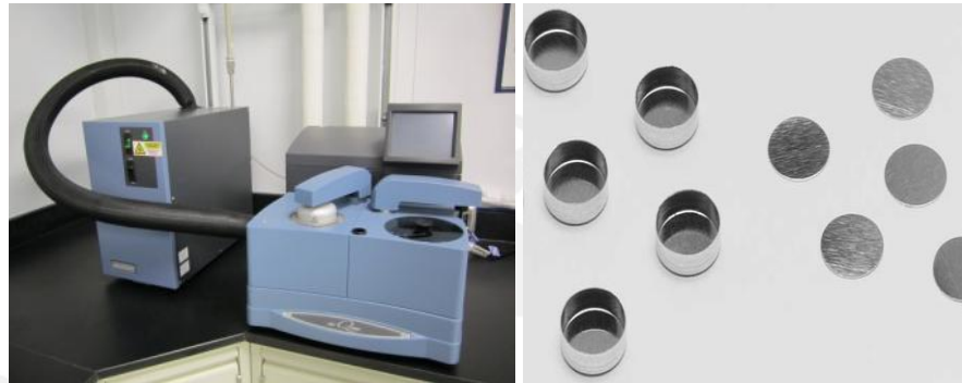
Figura 2.19. Equipo Calorímetro de barrido diferencial TA Q2000 y panes de aluminio.
