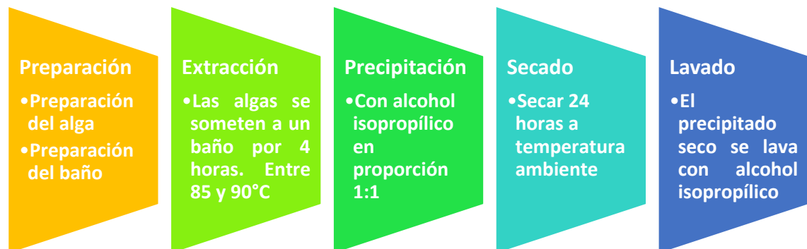
Figura 2.10. Esquema de la extracción de carragenina.
