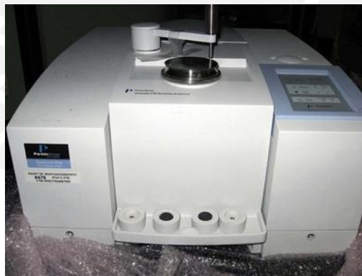
Figura 2.14. Espectrómetro Perkin Elmer Spectrum One IR con accesorio Universal ATR.
