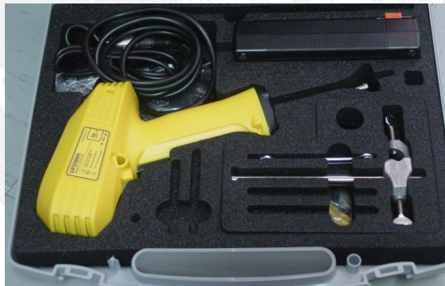
Figura 2.7. Equipo de agitación por ultrasonido UIP 200 Ht.
