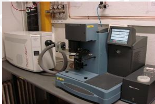
Figura 2.18. Equipo termogravimétrico TA Q500.
