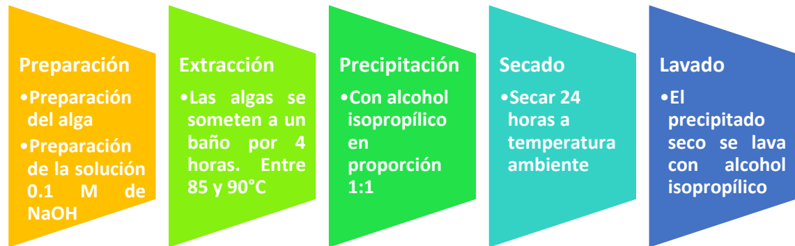
Figura 2.9. Esquema de la extracción de carragenina
