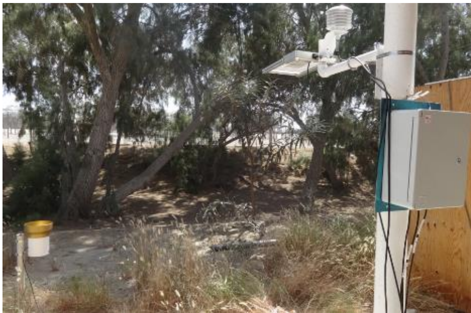
Figura 22 Sistema de adquisición de los parámetros ambientales Fuente: Elaboración propia.
