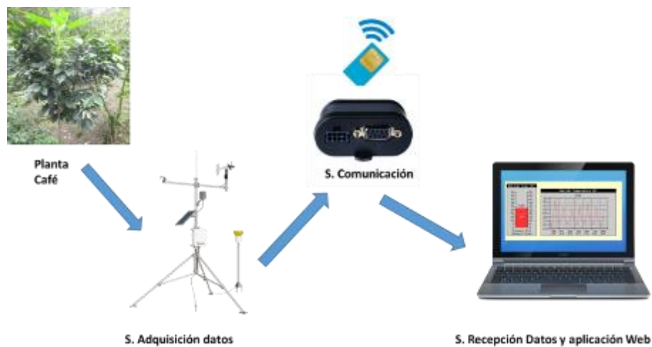
Figura 21 Sistema remoto de monitoreo de parámetros ambientales Fuente: Elaboración propia.
