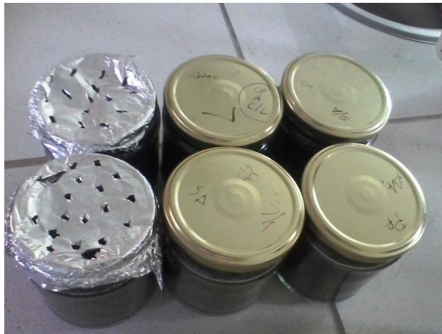
Figura 22. Contenedores de suelo artificial con pesticidas protegidos de la luz.
