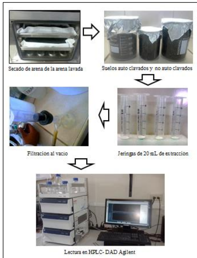
Figura 19. Proceso de extracción y determinación por HPLC
