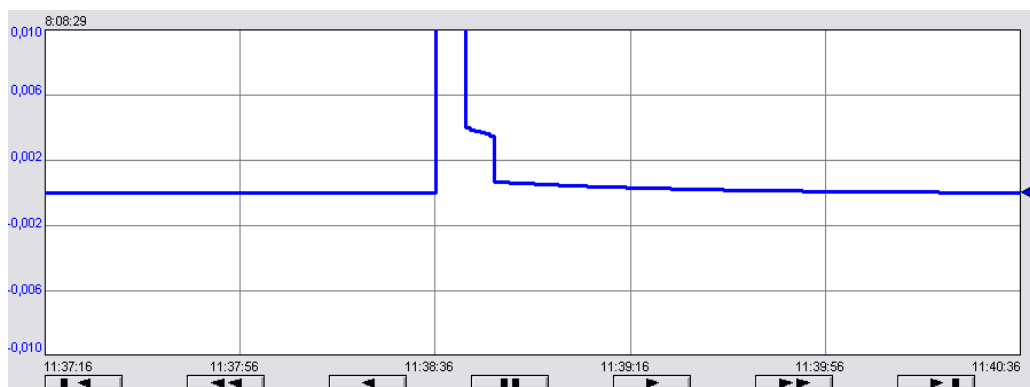
Figura 4.12. Simulación de falla en sensor de conductividad
