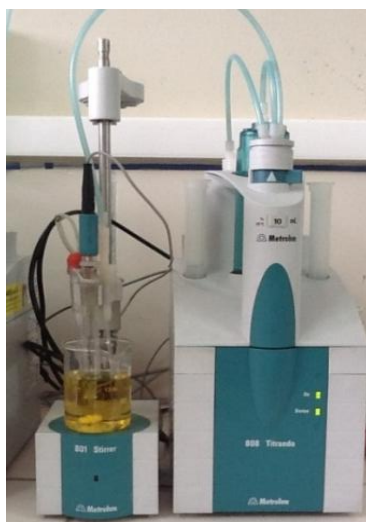
FIGURA 23. Etapa de titulación para la valoración de la solución de bisulfito de sodio.
