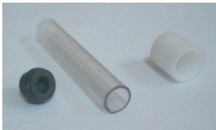
FIGURA 5. Diseño de dispositivo construido para el monitoreo de dióxido de nitrógeno.
