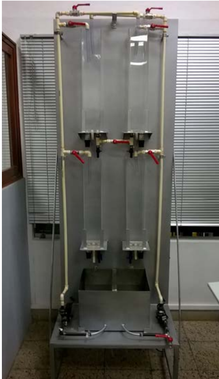
Figura 3. Módulo de cuatro tanques acoplados Fuente: Propia
