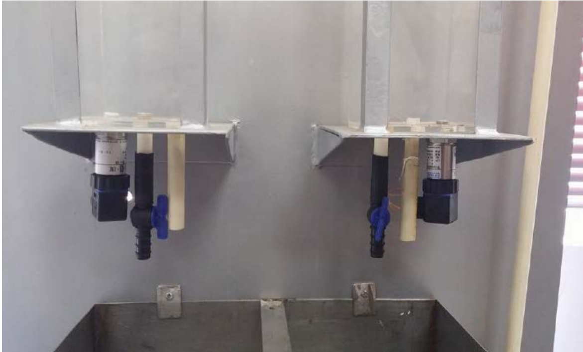
Figura 6. Ubicación de los sensores de presión diferencial Fuente: Propia
