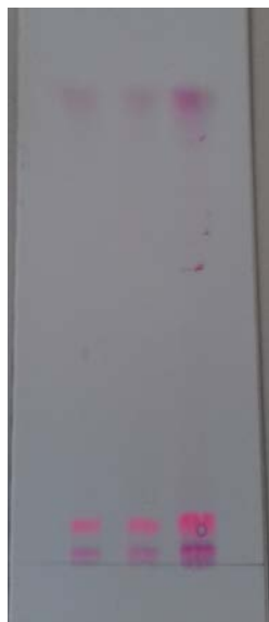
Fig. 16. Placa de TLC con FM acetato de etilo:metanol (9:1)
