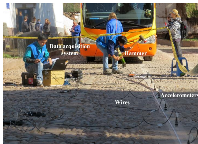
Figura 2.22: Configuración de los equipos realizada en campo para el ensayo MASW
