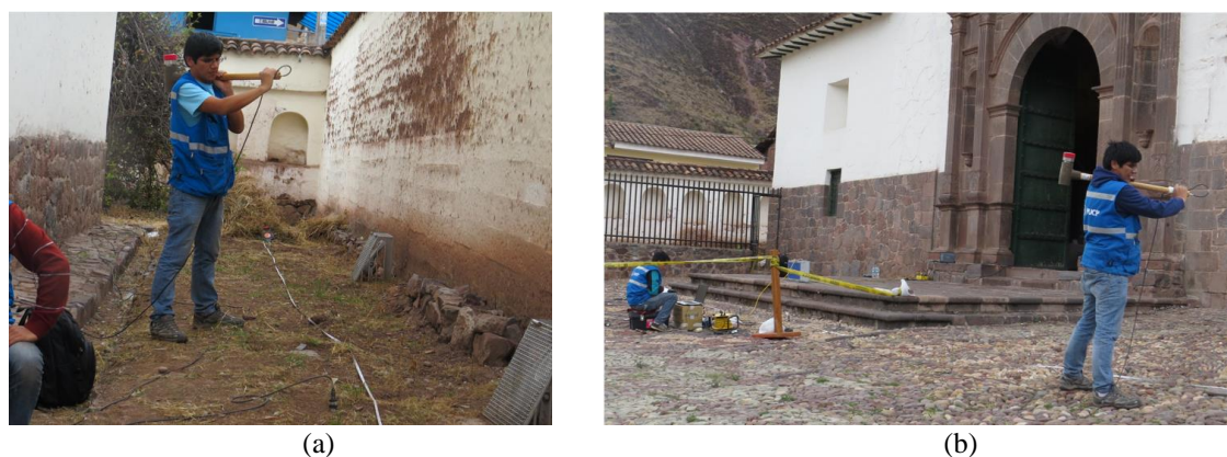
Figura 5.6: Ensayos MASW en (a) el frontis y (b) en el lateral Este de la Iglesia de Huaró
