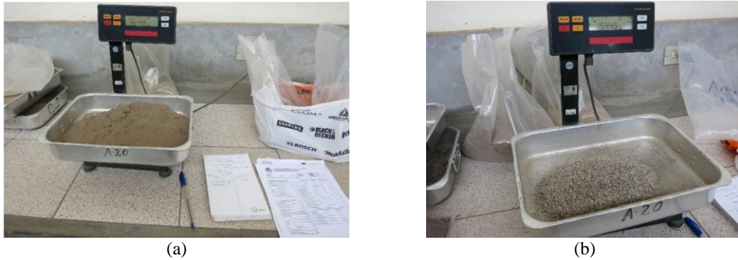
Figura 3.18: Muestra de (a) suelo recuperado y (b) arena del ensayo de cono de arena.
