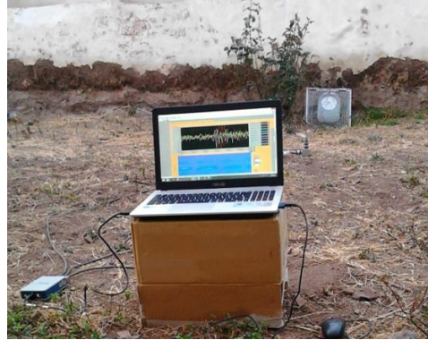
Figura 5.8: Ensayo H/V en el lado lateral de la iglesia.
