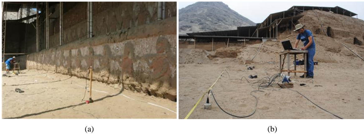
Figura 3.9: Ensayos MASW en (a) la fachada norte y (b) en la fachada oeste de la Huaca
