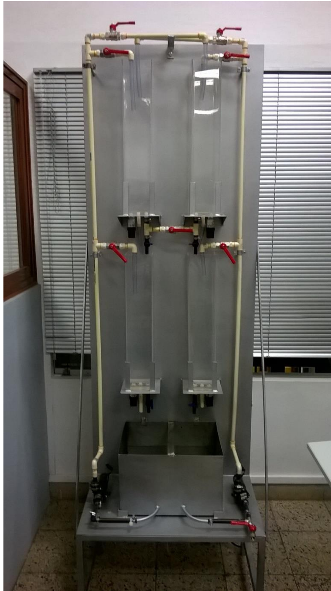
Figura 17. Fotografía del módulo de cuatro tanques acoplados. Fuente: Elaboración propia.
