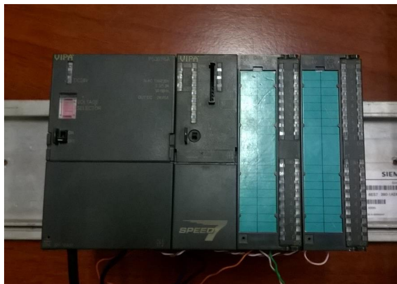
Figura 16. PLC VIPA 314 6CG03. Fuente: Elaboración propia.
