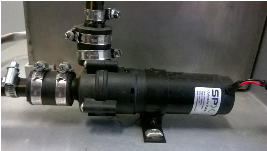
Figura 18. Bomba del lado izquierdo del módulo de cuatro tanques acoplados. Fuente: Elaboración propia.
