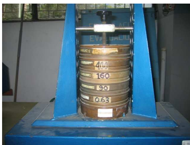
Fig. 6. Tamices utilizados para uniformizar el tamaño de las partículas, tanto de la harina de sangre de pollo y de muña.
