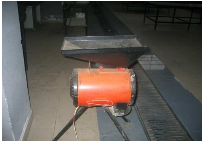
Fig. 5. Molino utilizado para moler o reducir el tamaño, tanto de la sangre de pollo cocida, triturada y deshidratada así como de la muña deshidratada y triturada.
