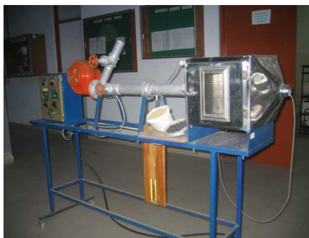
Fig. 4. Deshidratador utilizado para deshidratar, tanto la sangre de pollo cocido así como la muña triturada.
